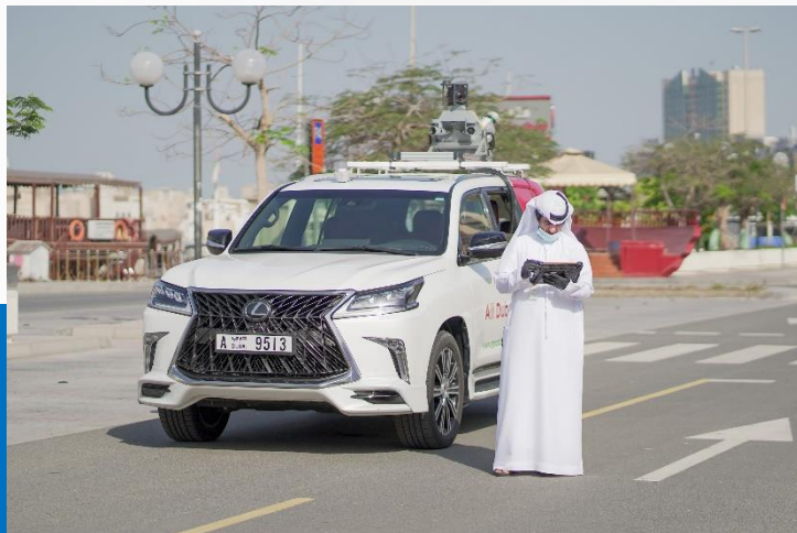
Mobile Mapping Equipment الأجهزة المستخدمة في المسح
